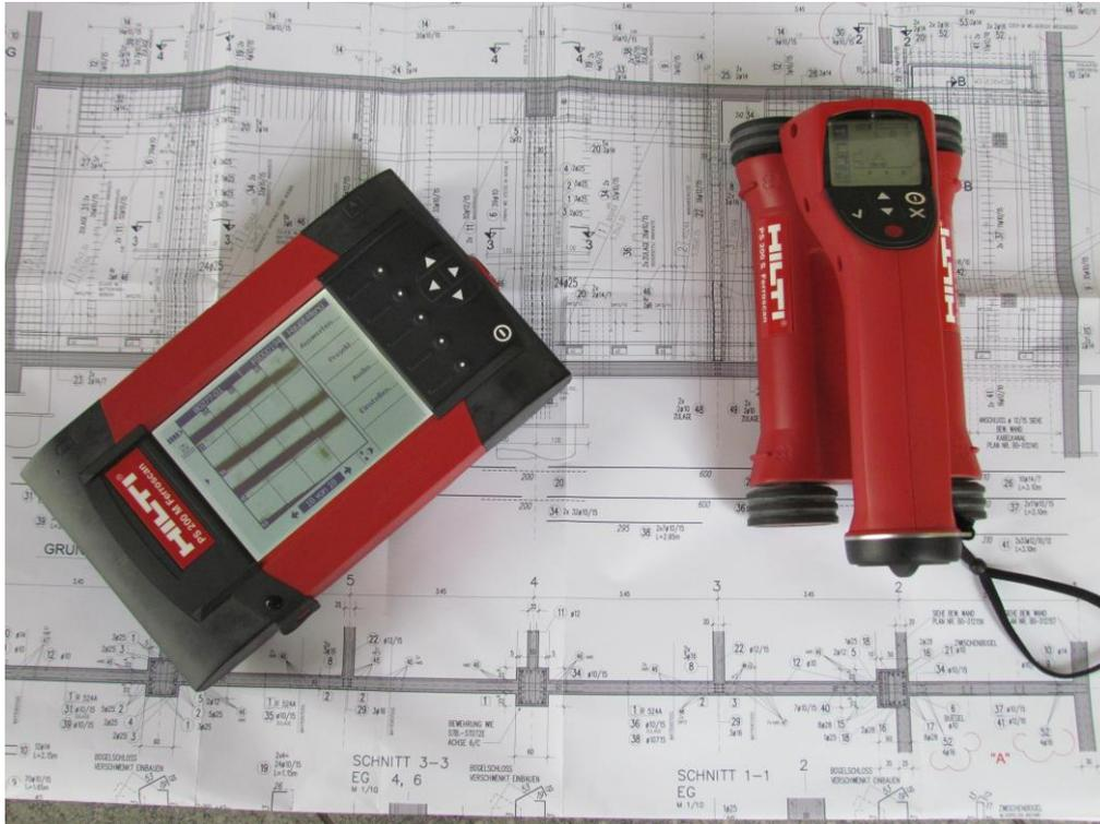
Die Tragfähigkeit von Stahlbetontragwerken wird neben der Betonfestigkeit im Wesentlichen durch die im Beton eingelegte Bewehrung bestimmt. Häufig sind bei bestehenden Bauwerken, deren Tragfähigkeit im Rahmen von Bauwerksuntersuchungen oder im Rahmen von geplanten Umbaumaßnahmen bewertet werden muss, keine Bewehrungspläne mehr verfügbar, die die notwendigen Informationen zur vorhandenen Bewehrung beinhalten.
